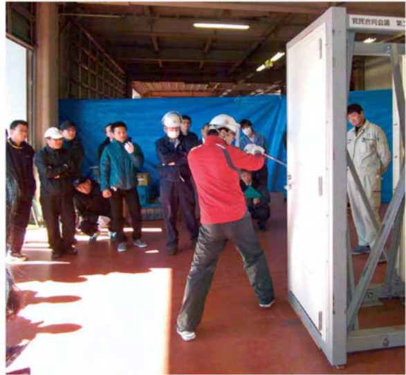
●建物防犯に関する知識・技能専科でのドア試験の様子
